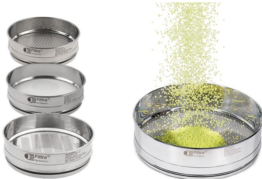
شکل 5- دسته بندی ابعادی فیلرها و در صد ابعادی هر بخش با استفاده از مش بندی دستگاه Sand Mesh Sieve صورت می پذیرد.
