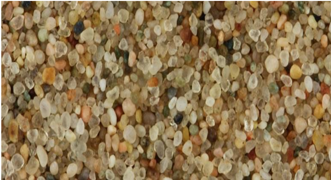
شکل 1- نمونه های فیلر مورد استفاده در لوله های کامپوزیتی می بایست بدون ناخالصی بوده و دارای لبه تیز نباشند
