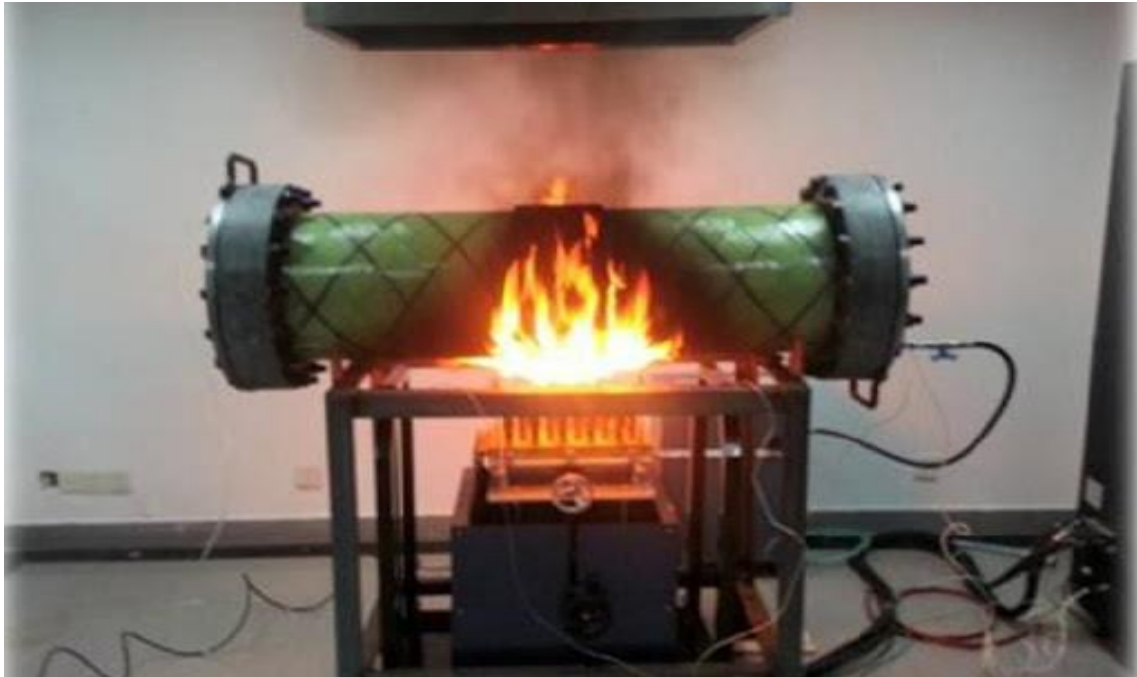
شکل ۲- فرآیند تست تاخیر در آتش لوله های فایبرگلاس از مهمترین اقدامات تولید لوله های صنعتی فایبرگلاس می باشد.
